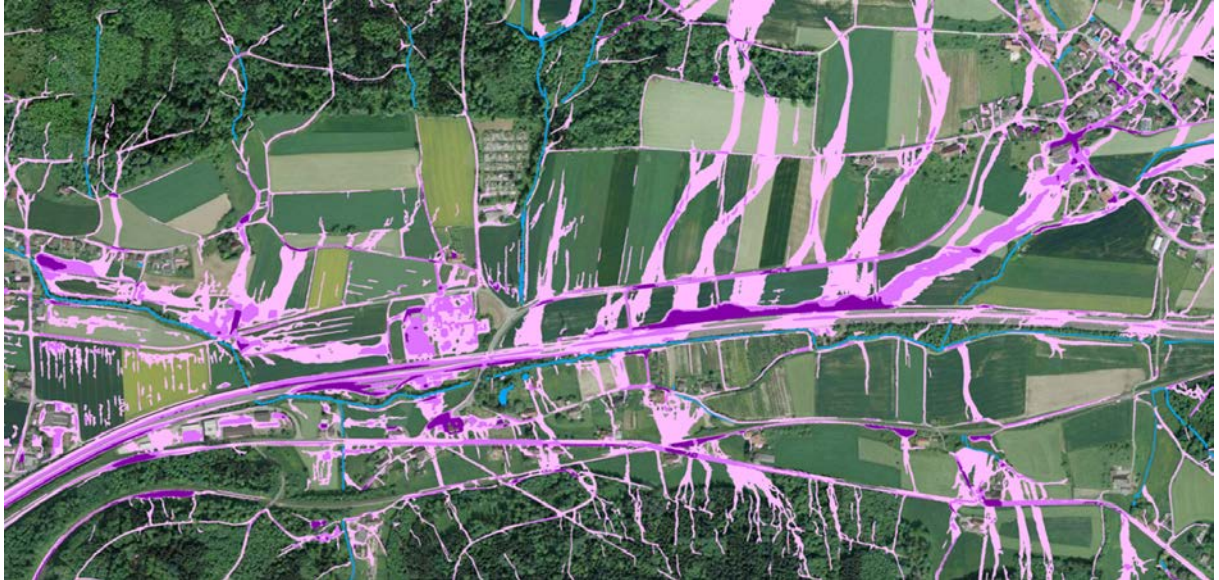
Abbildung 50: HQ100; Fliesstiefe <0.1m, Fliesstiefe 0.1-0.25m, Fliesstiefe > 0.25m [geo.admin.ch]
